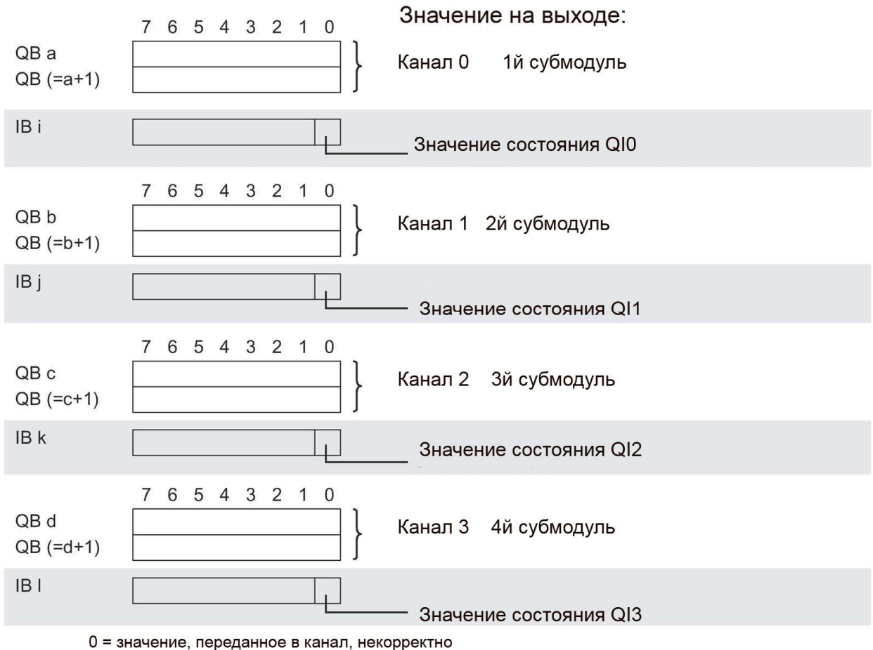
Рисунок 4-2 Пространство адресов модуля для конфигурации 4x1-канальный с оценкой состояния AQ 4xU/I HF S QI
