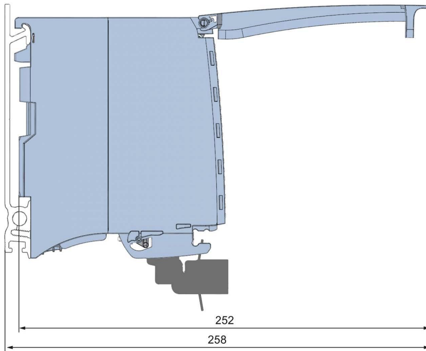
Рисунок А-2 Габаритный чертеж модуля AQ 4xU/I HF (вид сбоку, открытой передней крышкой)
