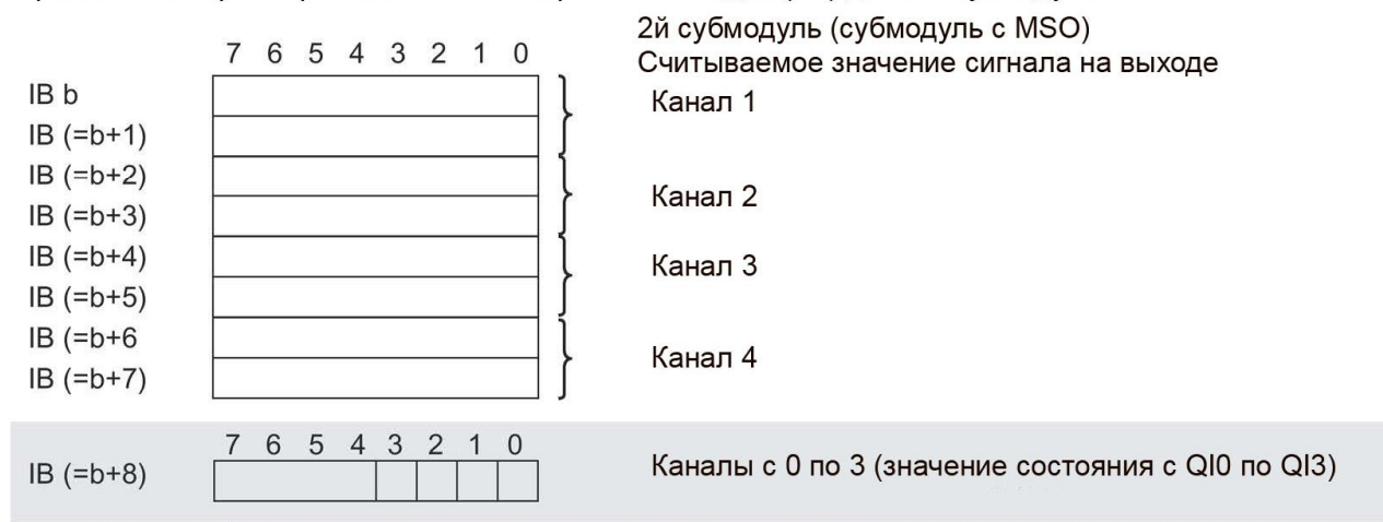
Рисунок 4-3 Адресное пространство для конфигурации 1x4 каналный AQ 4xU/I HF MSO с оценкой состояния
